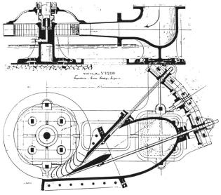
Bild 6. Vertikal- (oben) und Horizontalschnitt (unten) des Zuppingerschen Tangentialrades (nach Originalplan Sulzer-Escher Wyss).
