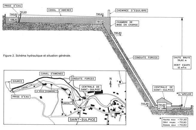
Le turbinage des eaux en une seule chute, avec de nouveaux groupes hydro-électriques, représentait la meilleure solution pour revaloriser les concessions de l'ENSA avec, en outre, les avantages suivants:
