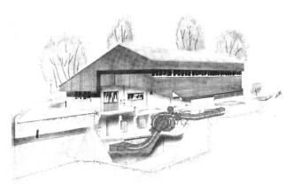
Figure 1. Centrale hydro-électrique de Saint-Sulpice équipée de quatre turbines Francis.
