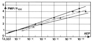
Bild 7. Verhältnis von 100jährlichem Niederschlag eines 24-Stunden-Regens zur PMP mit entsprechender jährlicher Überschreitenswahrscheinlichkeit AEP bei angenommener Gumbelverteilung. ( $\blacktriangle$ ) Werte grösser  $10^{-13}$  gemäss [2]. ( $\triangle - \cdot - \cdot \triangle$ ) 1.5 mal der 1000jährliche Niederschlag.
