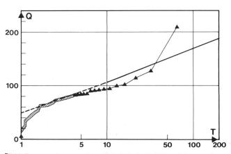
Bild 6. Frequenzdiagramm der unterhalb der im Fall 3 beschriebenen Anlage gelegenen Abflussmessstation gemäss [5]. Abfluss Q [m³/s] und Jährlichkeit T [Jahre].
