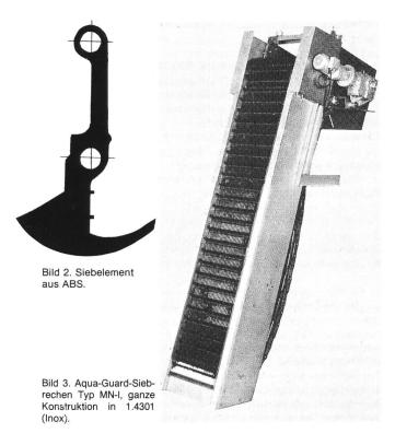
den mit Bandlaufgeschwindigkeiten von 1,5 bis 3,0 m/min aus dem Abwasser entfernt. Bei diskontinuierlichem Betrieb sollte das Band minimal eineinhalbmal umlaufen, damit kein Schmutz auf den Siebelementen antrocknen kann.
