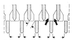
Bild 1. Siebbandausschnitt (Aufriss und Schnitt) mit angeschwemmten Ohrenstäbchen.
