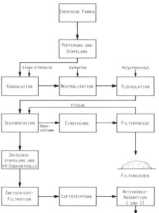
Bild 1. Schematischer Ablauf des Envi-Detox-Verfahrens.
