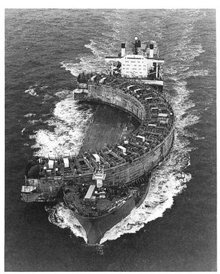
Bild 5. Transport eines der beiden Wandteilstücke mit einem Spezialschiff von Rotterdamm nach Norwegen.
