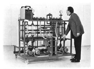
Bild 4. Elektrodialyse-Pilotanlage.
