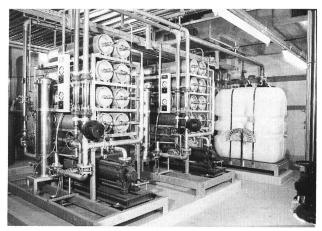
Bild 1. Christ-Osmostil-Gegenosmoseanlage für eine Leistung von etwa 20 m³/h. Solche Anlagen stehen in bewährter, standardisierter Ausführung in feiner Leistungsstufung zur Verfügung.
