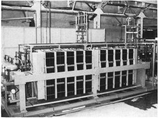
Bild 3. Elektrodialyseanlage.
