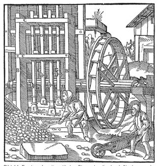
Bild 14. Erzstampfe mit vertikalen Stempeln, die durch Nocken an der Welle eines oberschlächtigen Wasserrades gehoben und wieder fallen gelassen werden (aus *G. Agricola:* De re metallica libri XII. Basel 1556).
