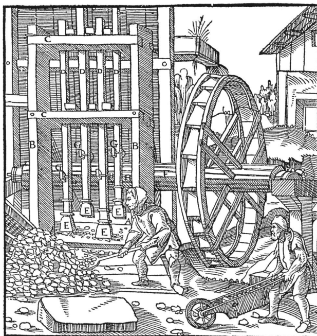
Bild 14. Erzstampfe mit vertikalen Stempeln, die durch Nocken an der Welle eines überschlächtigen Wasserrades gehoben und wieder fallen gelassen werden (aus G. Agricola: De re metallica libri XII. Basel 1556).
