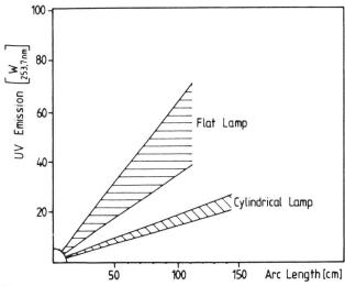
Bild 2. Leistungsdaten von Hg-Niederdruckstrahlern.
