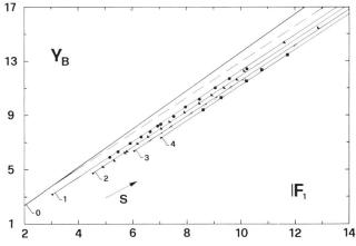
Bild 4. Konjugierte Wassertiefen  $Y(\mathbf{F}_1,S)$  für den B-Sprung. (---) S=0 bei Berücksichtigung der Wandreibung.
