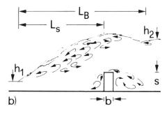
Bild 1. a) klassischer Wassersprung, b) Wassersprung mit Querschwelle.
