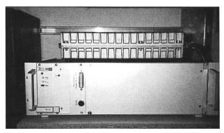
Bild 5. Tochterstation des Datenübertragungssystems in 19"-Rack und Sender-Empfänger (oben) mit Prüfbuchse.
