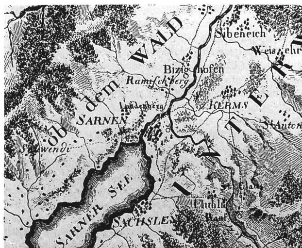
Bild 1. Tal der Sarneraa zwischen Sarnersee und Alpnachersee aus dem Atlas von Joh. Rudolf Meyer und Heinrich Weiss (1796; aus Grosjean, 1971 [1]): Die Grosse Melchaa fliesst noch unterhalb von Sarnen in die Aa. Im Jahr 1880 wurde der Bach korrigiert und in den Sarnersee geleitet, wo seither das Geschiebe aus dem Melchtal in einem Delta abgelagert wird.
