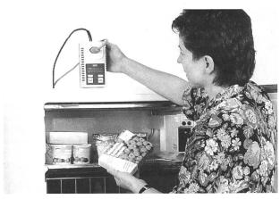
Bild 1. Um den Stromverbrauch des Kühlschrankes festzustellen, genügt ein Messgerät, das zwischen Steckdose und Kühlschrank geschaltet wird. Das EWZ leiht solche Messgeräte kostenlos aus.
