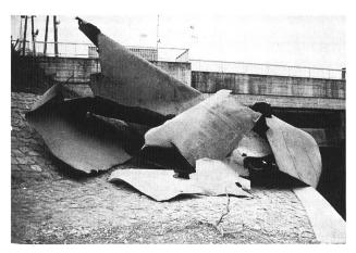
Bild 6. Teil der herausgerissenen und aus dem Unterwasser geborgenen Tosbeckenpanzerung.
