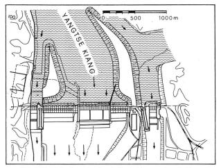
Das 2715-MW-Niederdruck-Laufwerk Gezhouba am Jangtsekiang besteht aus zwei Maschinenhäusern, einer Hochwasserentlastung, zwei Spülwehren und drei Schiffsschleusen.
