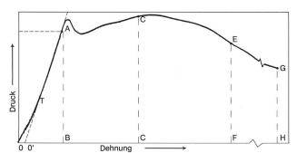
Bild 1. Spannungsdehnungsverhalten von Stahlfaserbeton zum Bestimmen seiner Biegezähigkeit nach ASTM C 1018 (USA).
