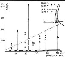
Piezodex-Messungen zur Bestimmung der Wasserdrücke im Fels unterhalb der Staumauer Valle di Lei. Die zum System gehörende Piezodex-Verrohrung wird in eine Bohrung eingeschoben und nach der Messung wieder ausgebaut. Die Lage der durch spezielle Packer abgegrenzten Messabschnitte wird an die festgestellte Klüftung angepasst. Die eigentliche Messung erfolgt mit der von Messpunkt zu Messpunkt verschobenen Gleitsonde.
