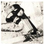
Rührwerke in Schlammstapelgruben von Kläranlagen
