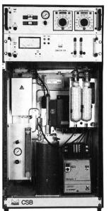
findet die Oxidation der organischen Moleküle statt. Mit der angeschlossenen Zirkoniumdioxid-Messzelle wird bei 745°C die Sauerstoffabnahme des Trägergases ermittelt. Je kleiner der chemische Sauerstoffbedarf ist, desto leichter sind die im Wasser gelösten organischen Stoffe abbaubar.
