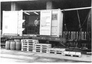
Transportable Wasserbehandlungsanlage, mit der benzinverschmutzte Abwässer von einem Grossbrand gereinigt werden.
