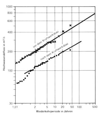
Bild 1. Sihl beim Sihlhölzli/Zürich. Messperioden: vor dem Kraftwerkbau 1896–1936, nach dem Kraftwerkbau 1946–1986 (ohne Kriegsjahre). Frequenzanalyse nach Log-Gumbel.
