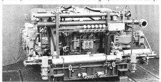
Fünfstufiger horizontaler Hochdruckluftkompressor Sulzer-Burckhardt für die Nassoxidationsanlage im Ciba-Geigy-Werk Monthey.
