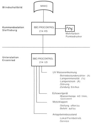
Bild 4. Schema des Leitsystems für die Trinkwasserversorgung Steffis-
