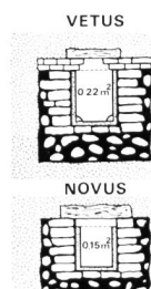
Bild 1. Typische Querschnitte der drei grossen Wasserzuleitungen nach Augst/BL (Augusta Raurica), Avenches/VD (Aventicum) und Windisch/AG (Vindonissa); die Flächenangaben beziehen sich auf den benetzten Querschnitt bis zur Oberkante des wasserdichten Verputzes.
