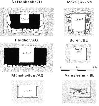
Bild 9. Typische Querschnitte von gemauerten, steinernen und tönernen Kleinwasserleitungen.
