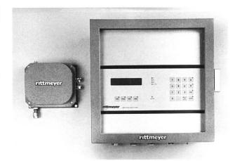
Die Messwerte stehen ausgangsseitig digital (BCD, Gray-Code, Binär-Code, 26 Bit) sowie analog 0/4 bis 20 mA, 0 bis  $\pm$ 10 V) zur Verfügung. Für die Analogausgänge kann der Ausgabebereich auf ein beliebiges Fenster eingeschränkt werden. Dies ist zum Beispiel sinnvoll, wenn der gesamte Messbereich gross ist, der Istwert für eine Regelung sich aber in einem kleinen Teilbereich bewegt.
