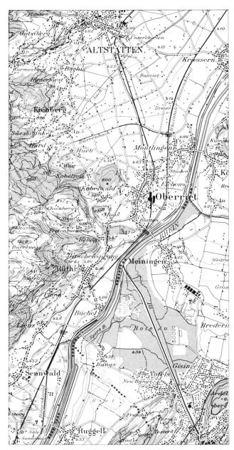
Bild 1. Situation (1:100000) der Binnenkanal-Kraftwerke. Zentrale Lienz: Das Nettogefälle bei  $Q_A=13~\rm m^3$  beträgt 3,4 m. Zentrale Blatten: Das Nettogefälle bei  $Q_A=14~\rm m^3$  beträgt 3,1 m. Zentrale Montlingen: Das Nettogefälle bei  $Q_A=14.5~\rm m^3$  beträgt 3,05 m. Reproduziert mit Bewilligung des Bundesamtes für Landestopographie vom 20.5.1988
