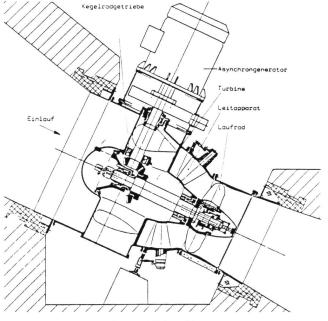
Bild 3. Schnitt durch die Kegelrad-Rohrturbine.
