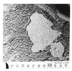
Bild 1. Beschichtungsschaden in einer Druckleitung.
