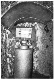
Bild 6. Staumauer Spitallamm. Lotanlage nach dem Umbau 1983 (System Huggenberger).
