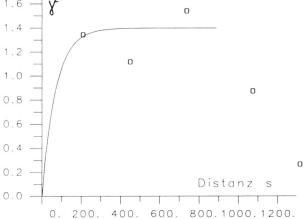
Bild 6. Variogramm des Logarithmus der Transmissivitäten: Kreise: Daten Lindenstaldenzelg; ausgezogen: theoretisches exponentielles Vario-
