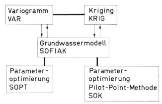
Bild 4. Programmsystem für Grundwassermodellierung; interaktiv auf Computersystem VAX-8650.
