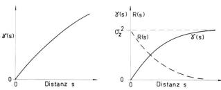
Bild 5. Schema eines Variogramms.  $\sigma_z^2$ : Varianz; R(s): Kovarianz.
