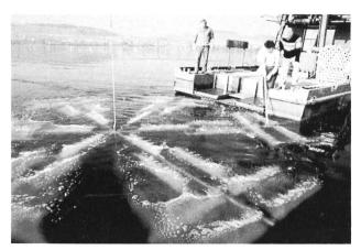
Bild 3b. Diffusor im feinblasigen Testbetrieb (Sommer).
