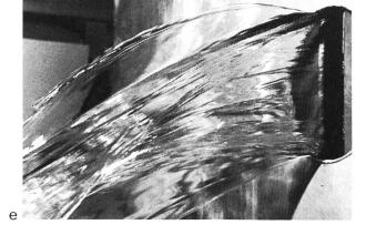
Bild 12. Ausflussstrahlen aus hochgestellter Rechtecköffnung.
