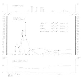
Bild 5. Färbversuchsdiagramm, erstellt mit Hilfe des Darstellungs- und Auswertesystems Hyddata. Parallel zur Darstellung der Konzentrationskurven läuft die Berechnung von Medianwerten. Diese werden mit dem Datenprotokoll in einer gesonderten Liste ausgegeben.
