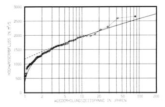
Bild 3. Hochwasserwahrscheinlichkeitsverteilung (Gamma-Verteilung), basierend auf den jährlichen Hochwasserspitzen (84 Jahre), beobachtet an der Station Rhein-Diepoldsau.
