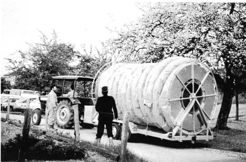
Bild 1, links. Die im Stauraum Eglisau ausgelegte Ölsperre. Bild 2, rechts. Die 230 m lange Sperre ist auf einem Haspel aufgewickelt, der seinerseits auf einem Anhänger montiert ist.
