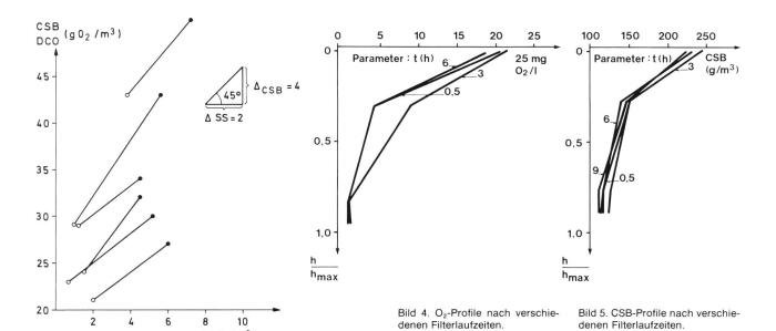
$SS (g/m^3)\\$  Bild 2. Darstellung der CSB-SS-Wertepaare am Eingang und am Ausgang der Flockungsfiltrationsanlage Richterswil [1].
