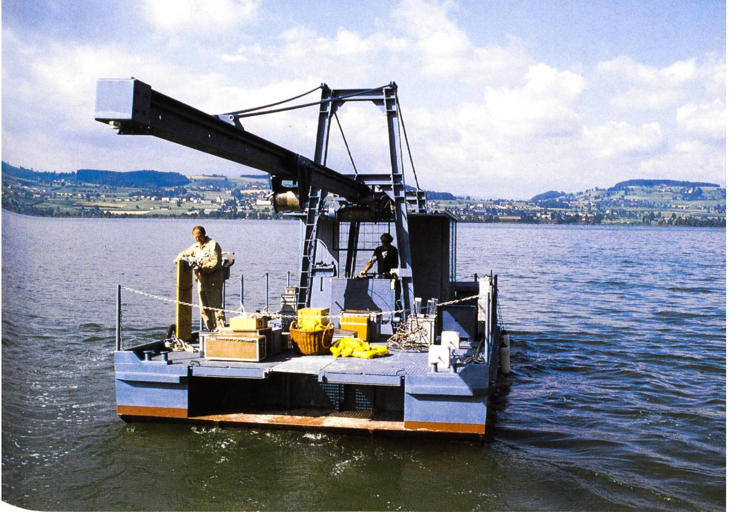
Seit 1984 wird das Tiefenwasser des Sempachersees im Sommer mit Sauerstoff belüftet, und im Winter wird er mit Hilfe von Druckluft künstlich durchmischt. Das Verhalten des Sees vor und während des Betriebes dieser see-internen Massnahmen wird mit dem abgebildeten Arbeitsfloss laufend untersucht.
