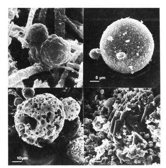
Strassenstaub bei starker Vergrösserung, die Zahlenangaben bedeuten Tausendstelmillimeter: Emission einer Hausölfeuerung (oben links), einer industriellen Kohlefeuerung (oben rechts), einer industriellen Schwerölfeuerung (unten links) und einer Kehrichtverbrennungsanlage (unten rechts).
