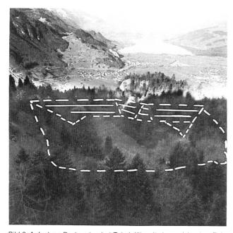
Bild 2. Aufnahme Beckenstandort Tobelplätz mit eingezeichnetem Bekken (Stauziel 882 m ü.M., 300000 m³ Nutzinhalt). Mit Schreiben vom 15. Januar 1988 des Elektrizitätswerkes Obwalden an den Regierungsrat Obwalden ersucht das EWO um die Teilauflage der Variante «Beckenstandort Tobelplätz» als Teil-Alternative zu dem vom EWO am 22.2.1983 eingereichten Konzessionsprojekt. Im ersten, aufgelegten Projekt wurde das Ausgleichsbecken am Standort «Lochkeller/Kleines Melchtal» vorgesehen.
