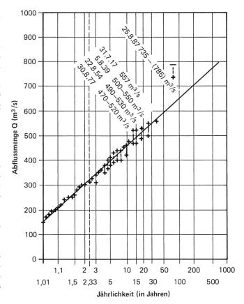
Bild 9. Frequenzdiagramm nach *Gumbel* für die Hochwasserspitze der Reuss bei Seedorf ( $E=832~\rm km^2$ , Messperiode 1914–1987), Abflussdaten der Landeshydrologie und -geologie.
