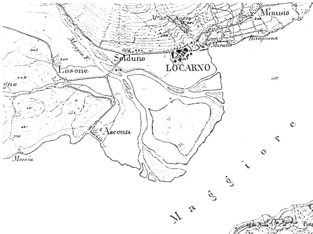
Bild 1. Das Maggiadelta im Jahre 1853 mit zwei Mündungsarmen in Richtung Locarno und Ascona, welche im Zuge der Maggia-Korrektion (1891 bis 1899) in einem geradlinigen Kanal zusammengefasst wurden.
