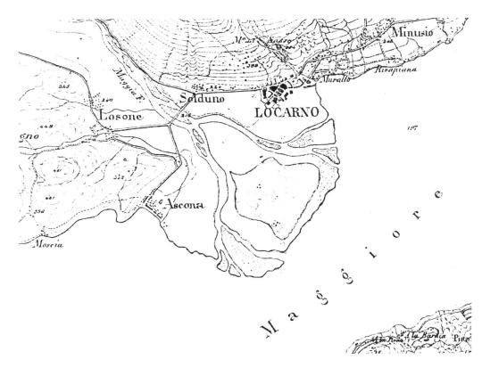
Bild 1. Das Maggiadelta im Jahre 1853 mit zwei Mündungsarmen in Richtung Locarno und Ascona, welche im Zuge der Maggia-Korrektion (1891 bis 1899) in einem geradlinigen Kanal zusammengefasst wurden.
