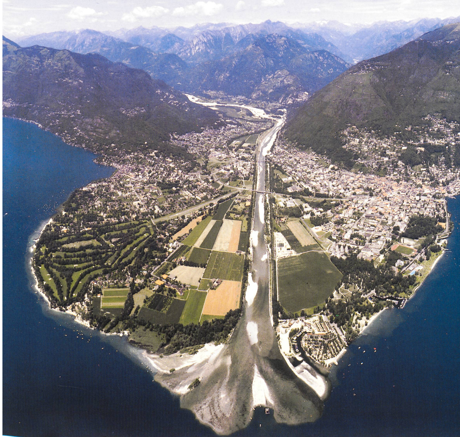
Das Delta der Maggia im Lago Maggiore aus 1400 m Flughöhe, aufgenommen am 15. Juli 1981 mit Ascona (links) und Locarno (rechts). Wiederholte Seegrundvermessungen ermöglichen eine Abschätzung der von der Maggia aus dem Einzugsgebiet verfrachteten Erosionsschutts. Aufgrund der neuesten Vermessung von 1984 beziffert sich der mittlere jährliche Eintrag seit 1952 auf rund 325 000 m 3 . Foto: Emil Schulthess , Zürich. Nachdruck aus «Geowissenschaften in unserer Zeit» (1987); A. Lambert : Sanduhren der Erdgeschichte, S. 10–18, Abb. 7.
