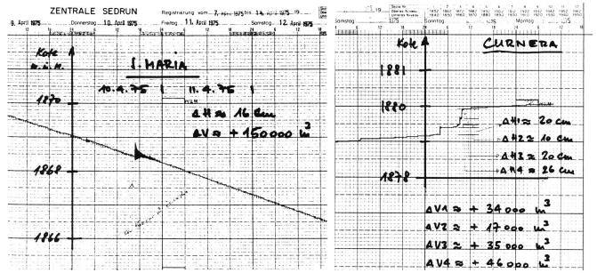
Bild 4. Aufzeichnung des Seespiegelanstieges und der abklingenden Wellenbewegungen an der Staumauer Sta. Maria. Die ausserordentliche Grösse der Lawine mit einem Wasservolumen von 150000 m³ vom 10. April 1975 vermochte den Seespiegel um 16 cm zu heben.
