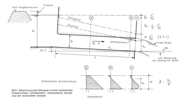
durch eine nicht-hydrostatische Druckverteilung und eine Asymmetrie der Geschwindigkeitsprofile gekennzeichnet ist. Da diese Stromfädenkrümmung im Endquerschnitt unbekannt ist, kann der dadurch erzeugte Unterdruck kaum berechnet werden. Die Lage der Drucklinie unter dem Stollenscheitel hängt von der tatsächlichen Druckverteilung am Auslauf, von den Rohrcharakteristiken, von der eventuellen Abstützung des Austrittstrahles auf die verlängerte Rohrsohle und endlich von der Durchflussmenge ab.
