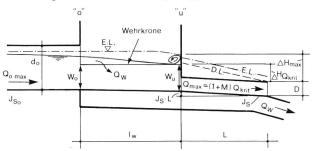
Bild 9c. Regenüberlauf unter extremen Randbedingungen. Maximaler Zufluss  $Q_{o_{max}}$ . Abfluss der maximalen Klärwassermenge  $Q=Q_{max}$ . Entlastung von  $Q_w$  über die Wehrkrone.
