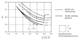
Bild 8. Quadratisches Rohr. Einfluss der Sohlenneigung auf β (Nach Li und Patterson [8]).
