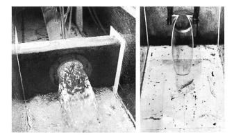
Bild 4, links. Modellversuch. Rohr mit allseitig belüftetem Auslaufstrahl.
