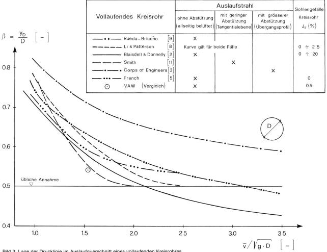
Bild 3. Lage der Drucklinie im Auslaufquerschnitt eines vollaufenden Kreisrohres.
