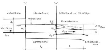
Bild 9a. Regenüberlauf: Längsschnitt. Abfluss von  $Q_{krit}$ . Die Drosselstrecke läuft voll, ohne Entlastung über die Wehrkrone ( $Q_w = 0$ ).
