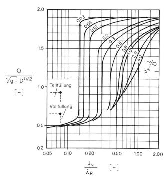
Bild 10. Bedingungen für ein selbsttätiges Füllen der Drosselstrecke, [7] [8].
