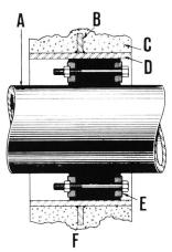
Bild 12a), links oben. Querschnitt nach fertiger Montage. Das Link-Seal stützt nicht nur das Mediumrohr ab, sondern nimmt auch Stösse und Vibrationen auf. Ein Kontakt von Metall zu Metall ist ausgeschlossen und verhütet somit Schäden an kathodisch geschützten Leitungen
