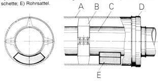
Bild 5. Stahlgleitrollenring mit Halteschelle.
