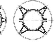
Bild 3. Oben: Kabelauflage Ausführung A (ultraschall-verschweisst); unten: Kabelauflage Ausführung B (verschraubt).
