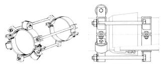
Mit den acht vorhandenen Grössen lassen sich alle Rohrdurchmesser von 20 bis 1500 mm abdichten, unter der Voraussetzung, dass der Spalt zwischen Rohr und Innenwand der Öffnung nicht kleiner als 12 und nicht grösser als 70 mm ist. Darüberliegende Abstände müssen von Fall zu Fall geprüft werden.
