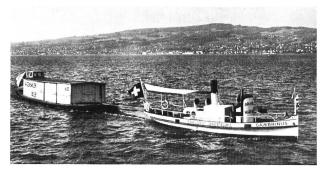
Bild 2. Das Schleppschiff «Gambrinus» ist das älteste Motorschiff auf dem Zürichsee. Es wurde im Jahre 1893 von der Firma Escher Wyss AG in Zürich als Dampfschiff gebaut. Die Dampfmaschine entwickelte 28 PS. Die Länge des Schiffes beträgt 13 m , die Breite 3,40 m. Im Jahre 1928 wurde die «Gambrinus» umgebaut. Die Dampfmaschine wurde durch einen 50-PS-4-Zylinder-Sulzer-Dieselmotor ersetzt. Die Glocke im Bug des Schiffes wurde seinerzeit von Keller in Zürich gegossen. (Photo Henn, Zürich)
