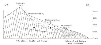
Bild 3. Schematisches Profil Eggishorn–Brunniquellen.
