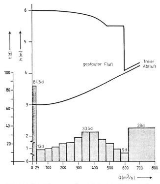
Bild 2. Verhältnis Abflussmenge Q zur Fallhöhe h des Wassers der Stauanlage Amerongen bei gestautem und ungestautem Niederrhein.
