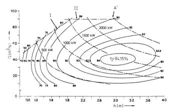
Bild 7. Hydraulischer Wirkungsgrad η (max. 94,15%) und Arbeitsvermögen A (kW) einer der vier Kaplan-Turbinen mit verstellbaren Leit- und Laufschaufeln der Wasserkraftanlage Maurik.
