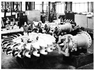
Laufrad einer 78,5-MW-Peltonturbine für das kolumbianische Kraftwerk Guatapé. Die Turbinen für Guavio sind für ungefähr dreimal mehr Leistung ausgelegt, müssen also dementsprechend grösser und massiver gebaut werden.
