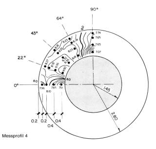
Bild 8. Vorgeschlagene Einlaufvariante. Hydraulisches Verhalten bei asymmetrischer Zuströmung. Fall mit einer der beiden Nachbarturbinen geschlossen.  $Q=145~{\rm m}^3/{\rm s}$ . Isotachenbilder.
