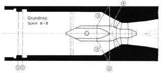
Bild 2. Kraftwerk Laufenburg: Schematische Darstellung der im Modell untersuchten neuen Einlaufform, mit Strafloturbine. Angegeben sind ebenfalls die benutzten Messprofile (Geschwindigkeits- und Druckmessungen) sowie das Verhältnis der entsprechenden Durchflussquerschnitte *F.*
