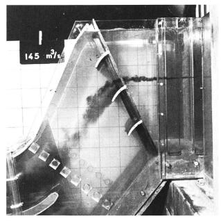
Bild 5. Ursprüngliche Form der Rechenquerträger: Ablösungserscheinungen am mittleren Träger bei  $Q=145~\rm m^3/s$  (Visualisierung der Stromfäden mittels Farbe).
