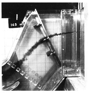
Bild 6. Optimierte Rechenform. Strömung im Bereich des mittleren Trägers bei  $Q=145~\mathrm{m}^3/\mathrm{s}$ .
