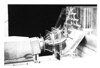
Bild 3. Modellnachbildung des Einlaufes mit Rechen und Turbinenkörper (Proiektvariante).
