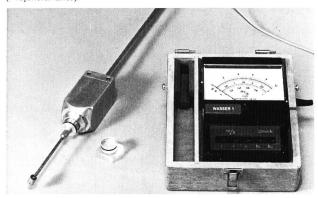
Bild 4. Geschwindigkeitsmessung. Messgerät mit Messflügel (Durchmesser 10 mm), Anzeige und Adapter für den Einsatz im Modell. Wenn die Sonde nicht eingesetzt ist, wird die Öffnung mit dem abgebildeten Zapfen aus Plexiglas verschlossen.
