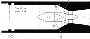
Bild 2. Kraftwerk Laufenburg: Schematische Darstellung der im Modell untersuchten neuen Einlaufform, mit Strafloturbine. Angegeben sind ebenfalls die benutzten Messprofile (Geschwindigkeits- und Druckmessungen) sowie das Verhältnis der entsprechenden Durchflussquerschnitte *F.*
