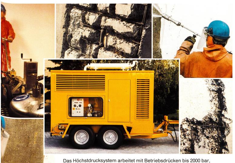
ohne zusätzliches Strahlgut, nur mit der hohen Energie des Wasserstrahls.
