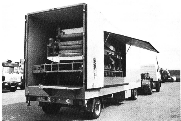
Eine Von-Roll-Siebbandpresse auf einem Anhänger kommt seit 1. Februar 1987 in der Region «Terre Sainte» zum Einsatz. Die Gemeinden Commugny-Coppet, Mies-Tannay, Founex-Céligny, Chavannes-de-Bogis/Bogis-Bossey und Prangins haben diese mobile Anlage gemeinsam angeschafft, um die Kosten für die Schlamm entwässerung tief zu halten.
